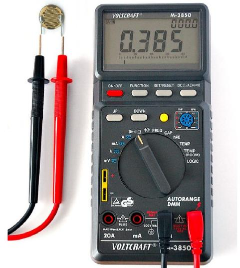
Illustration 37: Principe de mesure de la luminosité à l'aide d'une photorésistance.
