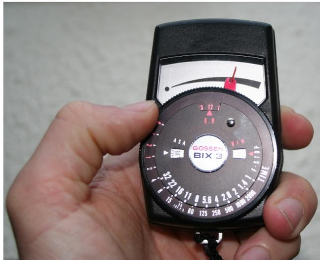
Illustration 36: Utilisation d'un posemètre photographique. L'intensité lumineuse mesurée est ici de 12 EV.
