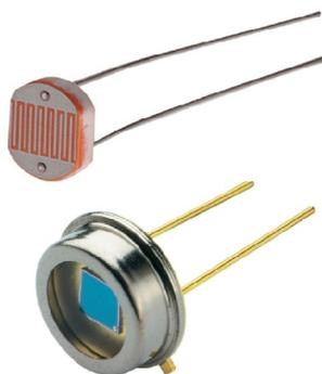
Illustration 38: Photorésistance (en haut) et photodiode (en bas).
